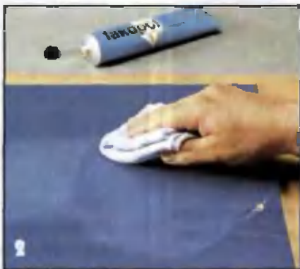
Затем деталь полируют специальной полировальной пастой.
