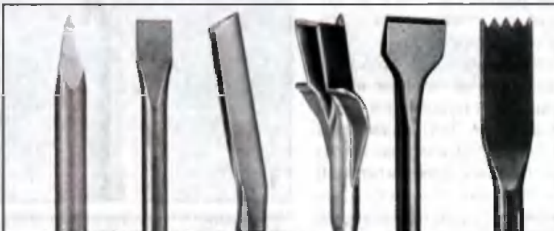
Долота (слева направо): пикообразное и плоское — для общих работ, желобчатое — для выборки небольших канавок в бетоне, шаберное — для выборки каналов глубиной 10–35 мм, плиточное — с эргономично отогнутым резцом, зубчатое — для долбления штукатурки и удаления раствора из швов кирпичной кладки.
