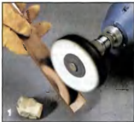
Тканевый полировальный круг состоит из нескольких сшитых между собой слоев хлопчатобумажной ткани. Полировальная паста придает заготовке зеркальный блеск.
