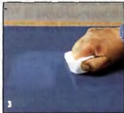
Остатки полировальной пасты вытирают мягкой тряпкой. Затем на поверхность плексигласа наносят антистатическое средство для чистки пластика.
