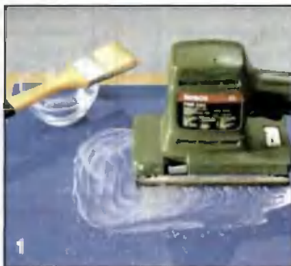
Пограрапанную поверхность пластмассовой детали (здесь — плексиглас) сначала обрабатывают увлажненной шлифовальной шкуркой зернистостью до 600 вручную или виброшлифовальной машинкой.
