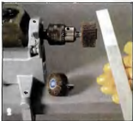
С помощью лепестковой шлифовальной насадки из шкурки зернистостью 60–150 поверхности деталей из нержавеющей стали придают шелковисто-матовый блеск. Вместо лепестковой насадки в патроне можно зажать и другие шлифовальные инструменты.
