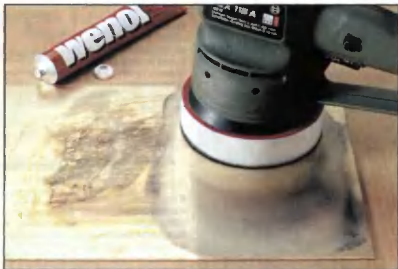
При полировании металлических деталей с помощью шлифовальной машинки полировальную пасту наносят на заготовку.
