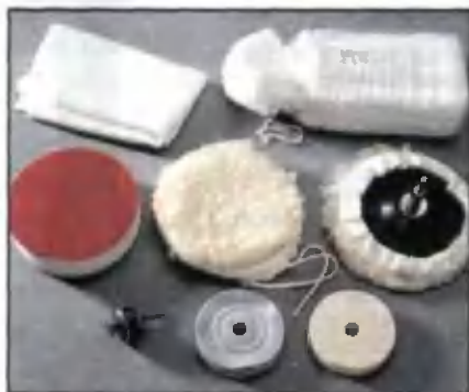
Средства для нанесения полировальной пасты и полирования вручную и машинным способом.
